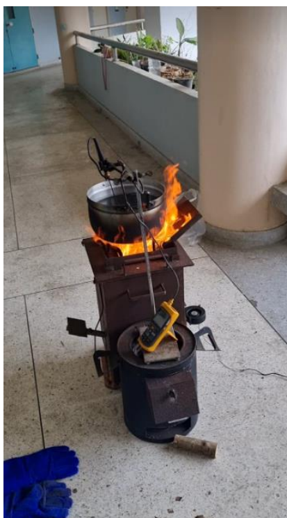
รูปที่ 3.8 ทดสอบการใช้งานเตาชีวมวลชนิด TLUD ที่สามารถปรับระดับห้องเผาไหม้
